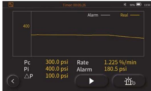
la visualizzazione a grafico consente di avere un controllo sull'andamento delle misure di pressione nel tempo.
